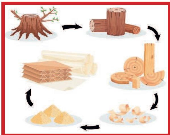
Бумагу делают на бумажных фабриках. В качестве сырья используется дерево различных пород, например сосна или тополь. Брёвна очищаются от веток и коры и измельчаются до тонких волокон. Измельчённое дерево отправляется вариться в котле с водой и кислотами.
