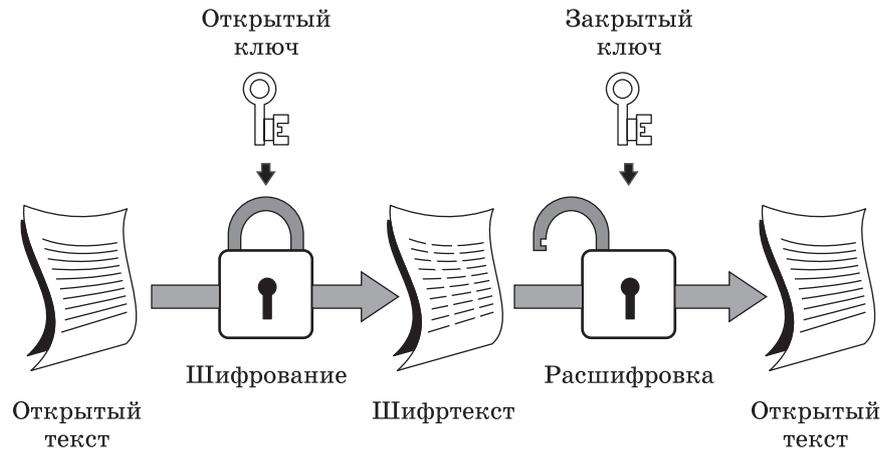
**Рис. 2.** Схема работы алгоритма RSA
