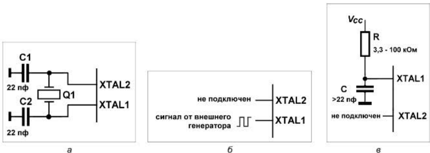
Рис. 2.3. Способы тактирования МК AVR с использованием внешних элементов: а — кварцевого резонатора; б — внешнего генератора; в — RC-цепочки
