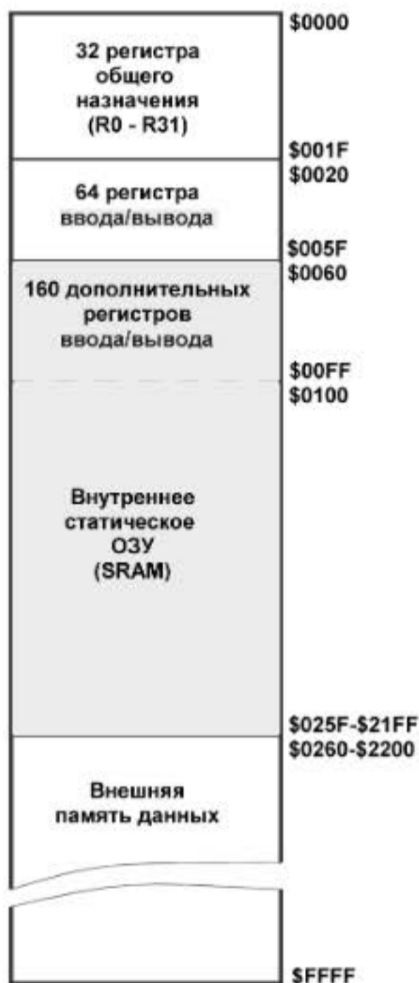
Рис. 2.2. Адресное пространство статической памяти данных (SRAM) микроконтроллеров AVR
