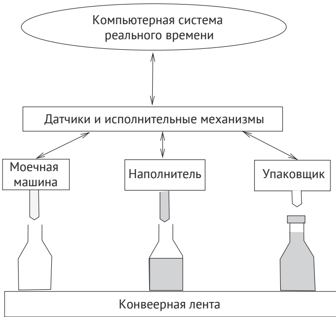
Рис. 1.3. Архитектура типичной системы реального времени
