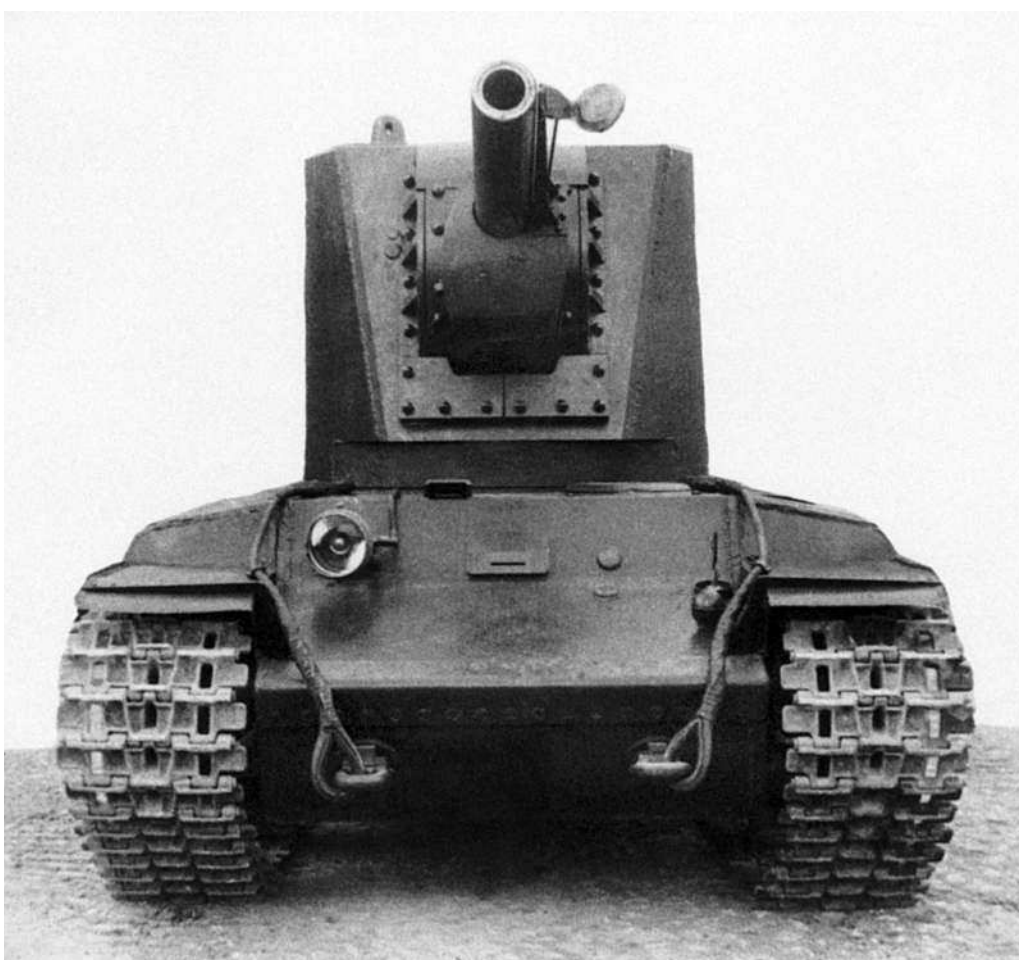
Танк КВ № У-4, вид спереди. Весна 1940 года. На этом фото хорошо видна крышка, установленная на стволе гаубицы, и механизм для ее открытия и закрытия (РГВА).
