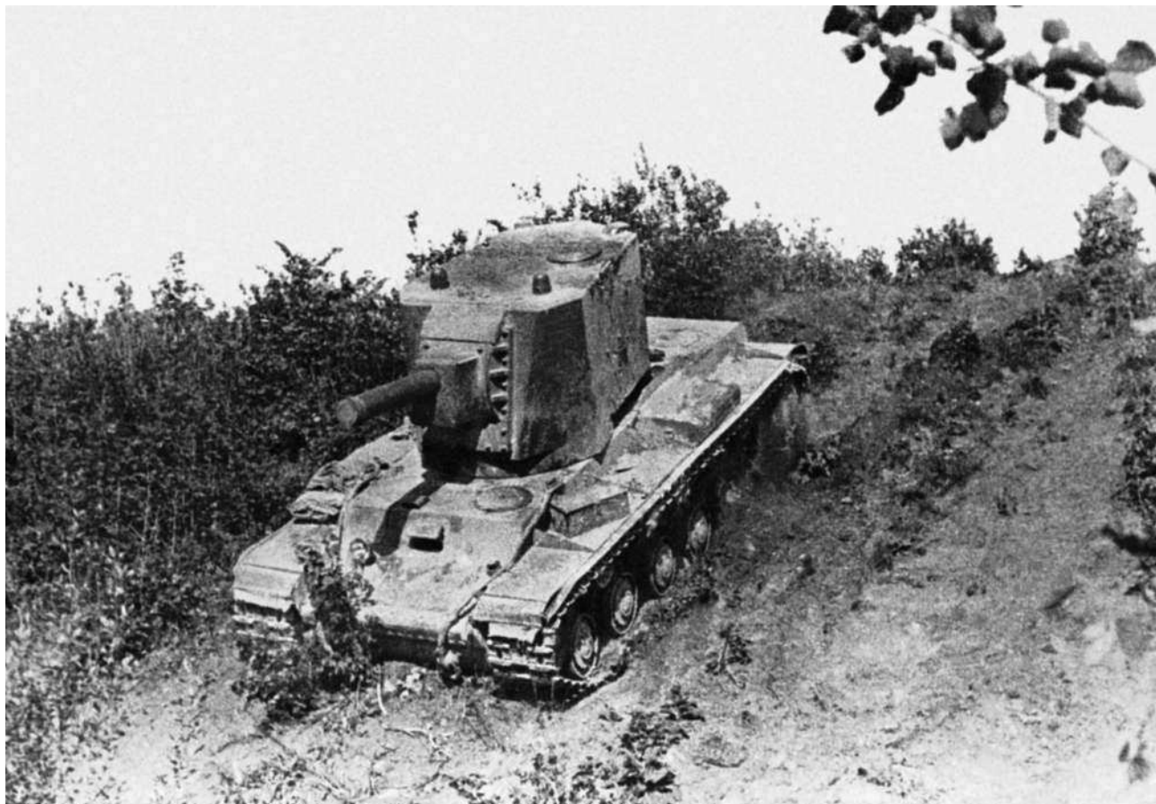
Испытание танка № У-1 с большой башней. Район Ленинграда, июнь 1940 года. На этом фото хорошо видна крыша танка (АСКМ).
