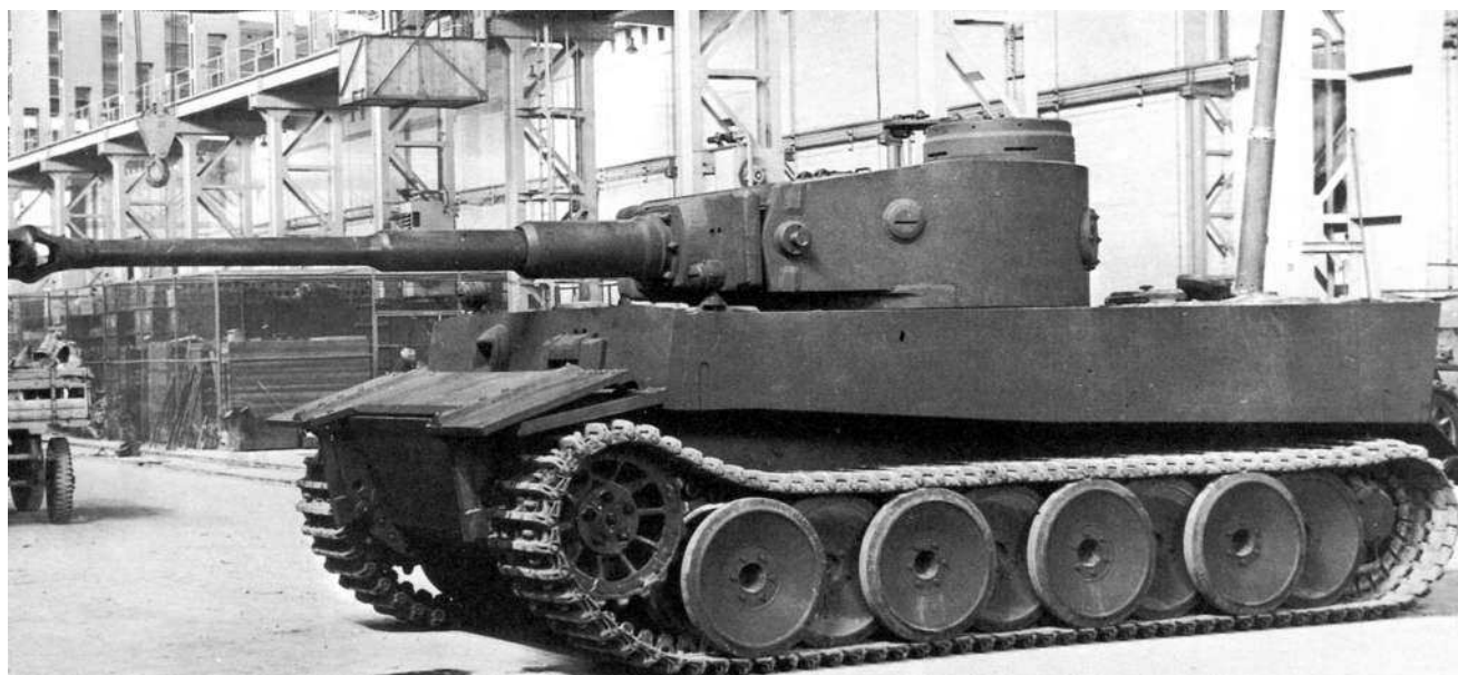
Первый прототип «Тигра» в заводском цехе. На первом прототипе была установлена специальная бронезащита передней части гусениц. В походном положении она укладывалась на верхний лобовой лист корпуса.
