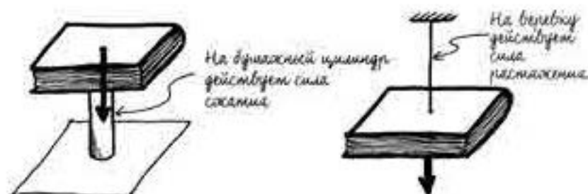
Опора книги с помощью сжатия (слева) и растяжения (справа).
