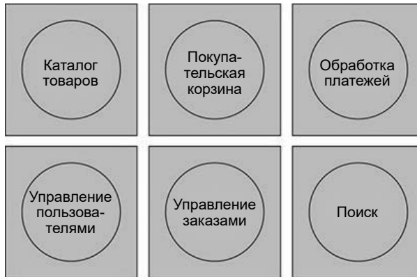
Рис. 1.6 ❖ Компоненты системы электронной коммерции, выделенные в отдельные микросервисы
