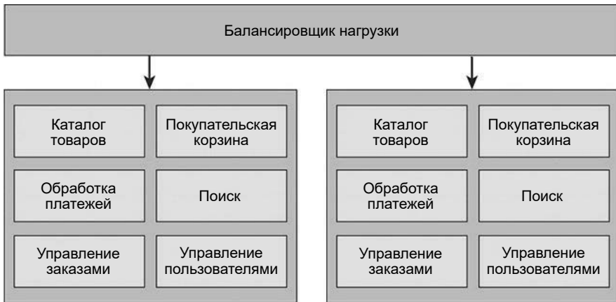
Рис. 1.5 ❖ Основные компоненты монолитной системы электронной коммерции
