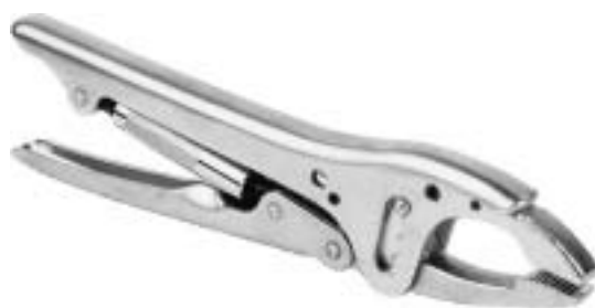
Рис. 3.5. Плоскогубцы с фиксацией: действуют как обычные плоскогубцы, но дополнительно имеют фиксирующий механизм, который держит щечки зажатыми
