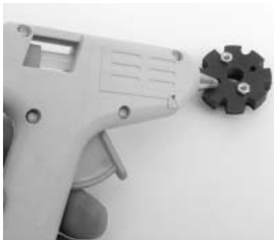
Рис. 3.8. Силиконовый клей из термопистолета быстро и надежно скрепит детали вместе
