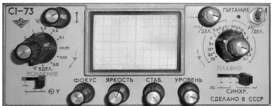
Рис. 2.5. Панель малогабаритного аналогового осциллографа С1-73
