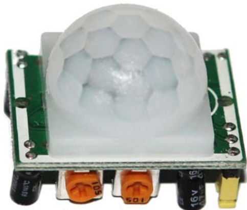
Рис. 1.9. Датчик движения с линзой Френеля
