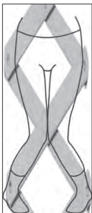
Рис. 193. Слева: пример некорректного разворота тазобедренных, коленных и голеностопных суставов; справа: суть работы шарнирной системы
