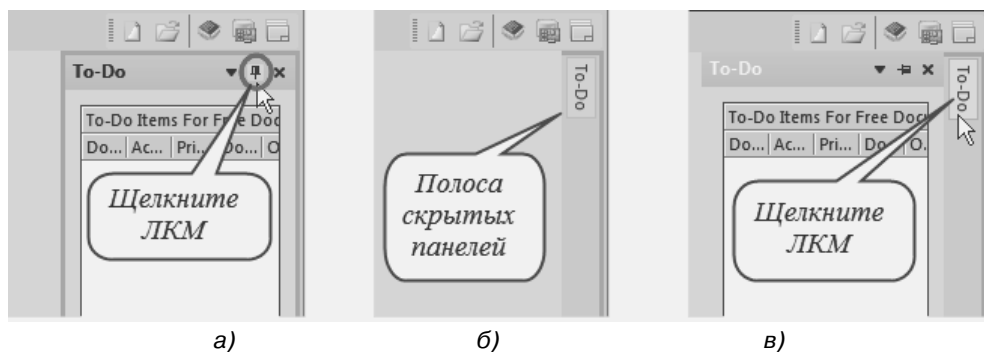
Рис. 1.15. Незафиксированные прикрепленные рабочие панели: а) переключение кнопки фиксации; б) ярлык панели в полосе скрытых панелей; в) выбор скрытой панели
