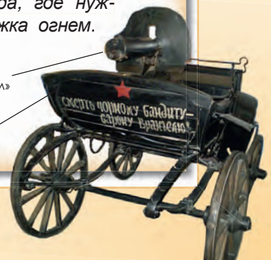
телега на рессорах – упругих подвесках, уменьшающих тряску
