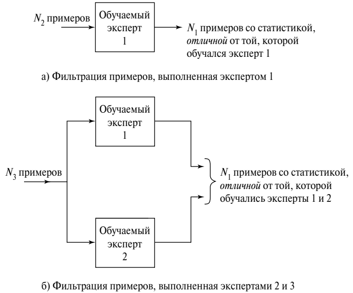
Рис. 7.2. Графически представленный процесс усиления за счет фильтрации
