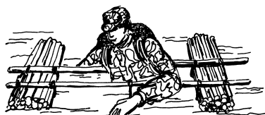
Рис. 59. Плот на связках из жердей для переправы одного человека
