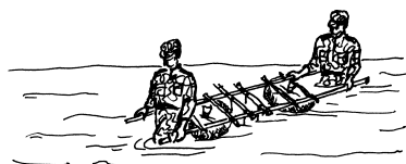
Рис. 60. Плот из двух плащ-палаток, заполненных сеном, соломой или другими материалами
