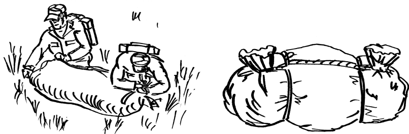
Рис. 53. Плащ-палатка, набитая сеном или соломой для использования ее в качестве опоры в плотках
