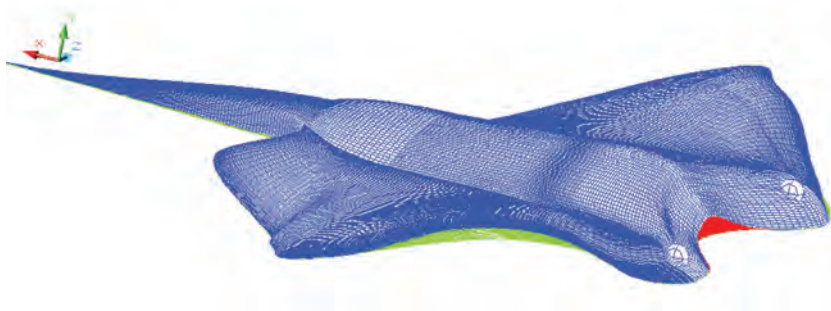
Рис. 1.5. ❖ Трёхмерная каркасная модель «чёрного дьявола»
