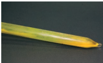
Рис. 4. Запаянная ампула с жидким хлором
