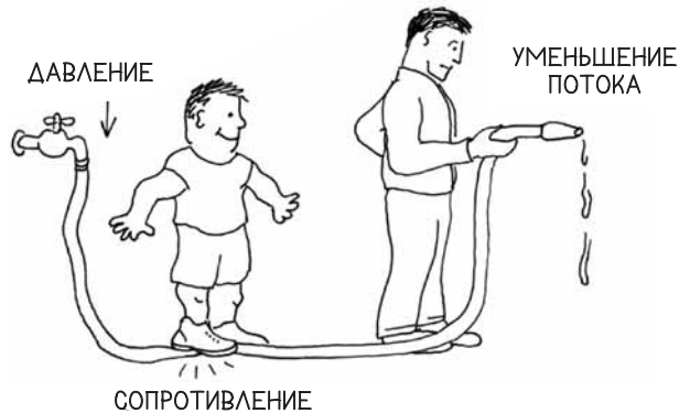
Рис. 1.31. Сопротивление препятствует давлению и уменьшает поток как воды, так и электричества
