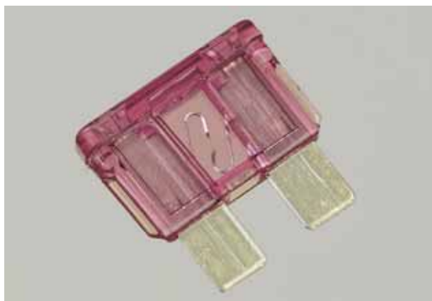
Рис. 1.34. Обратите внимание на разрыв плавкой вставки
