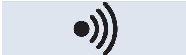
Рис. 1.7. Этот символ означает очень полезную функцию «прозвонки» цепи
