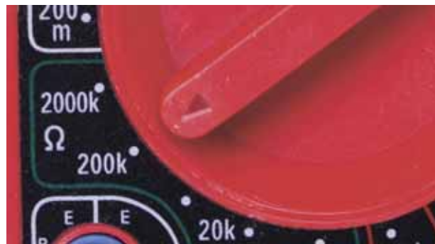
Рис. 1.23. Другой циферблат мультиметра с ручным выбором режима, но принцип тот же
