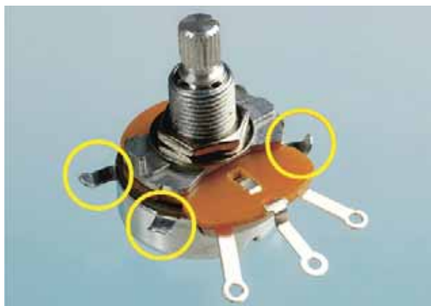
Рис. 1.45. Лапки потенциометра отогнуты вверх и наружу
