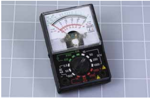
Рис. 1.1. Этот аналоговый измерительный прибор не подходит для наших целей. Вам понадобится цифровой мультиметр
