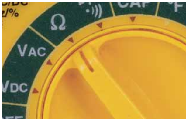
Рис. 1.21. На мультиметре с автоматическим выбором диапазона просто установите указатель на символ Ω (омега)
