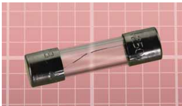
Рис. 1.35. В перегоревшем патронном предохранителе появляется аналогичный разрыв
