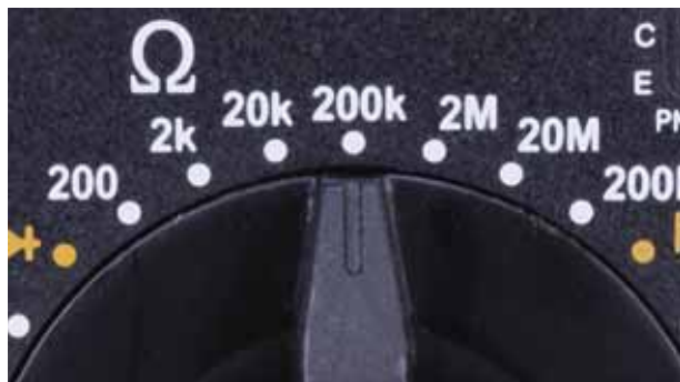
Рис. 1.22. Ручной мультиметр подразумевает, что вы самостоятельно выбираете диапазон
