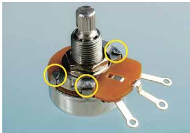
Рис. 1.44. Лапки, которые скрепляют потенциометр
