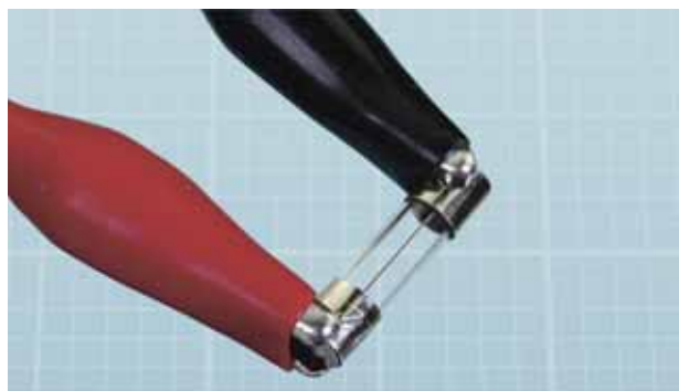
Рис. 1.33. Как прикрепить щупы к маленькому патронному предохранителю
