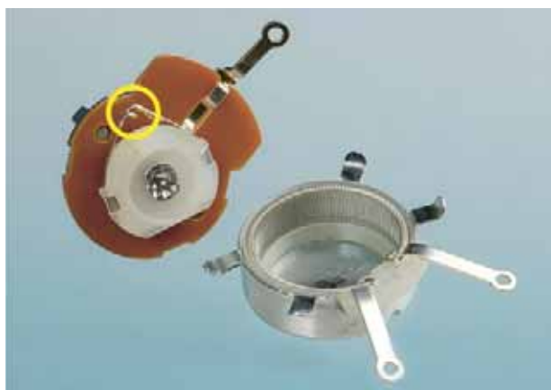
Рис. 1.46. Корпус потенциометра разобран (кружком выделен движок)
