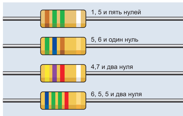
Рис. ЦВ-1.41. Четыре примера цветовой маркировки резистора
