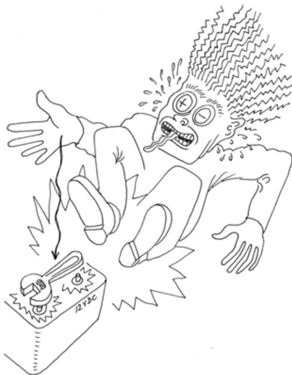
Рис. 1.27. Падение ключа на клеммы автомобильного аккумулятора может привести к печальным последствиям. Короткое замыкание может быть очень сильным даже при напряжении «всего лишь» 12 В, если аккумулятор достаточно энергоемкий
