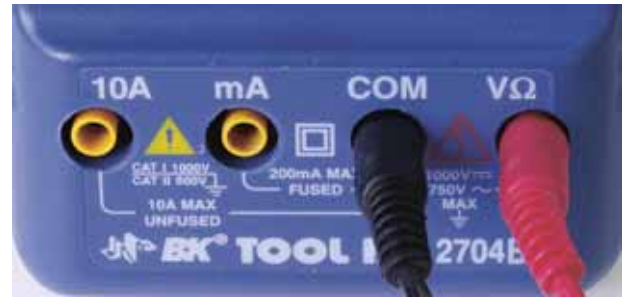
Рис. 1.18. Обратите внимание на маркировку гнезд этого мультиметра
