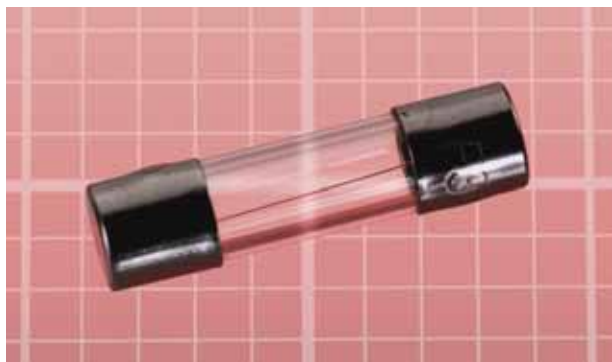
Рис. 1.13. Патронный стеклянный предохранитель сложнее захватить зажимами «крокодил»
