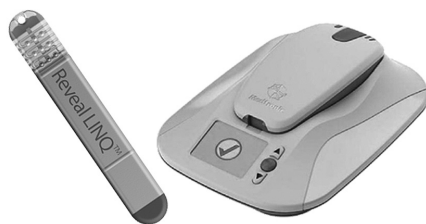
Рис. 1.9. Имплантируемый аппарат Reveal LINQ ICM с петлевым типом записи электрокардиограммы и MyCareLink Monitor, посылающий информацию врачу
