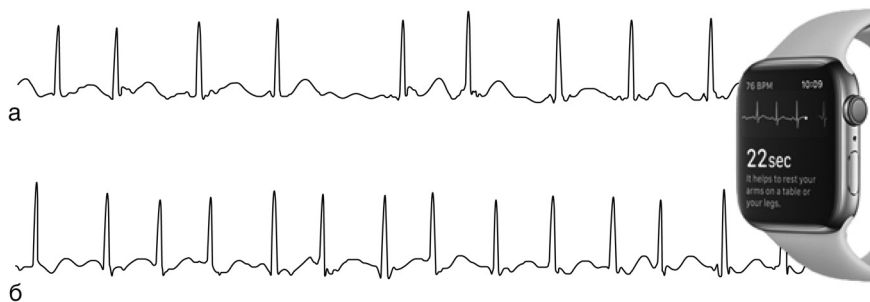
Рис. 1.11. Электрокардиограмма, зарегистрированная Apple Watch и расцененная устройством как наличие фибрилляции предсердий (частота сердечных сокращений 120 в минуту, а) и отсутствия таковой (частота сердечных сокращений 150 в минуту, б)
