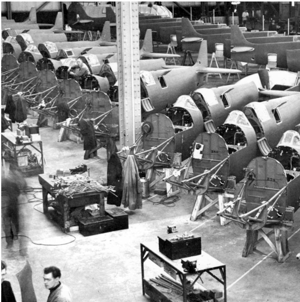
Сборка фюзеляжей «Спитфайров» на заводе SBAF
