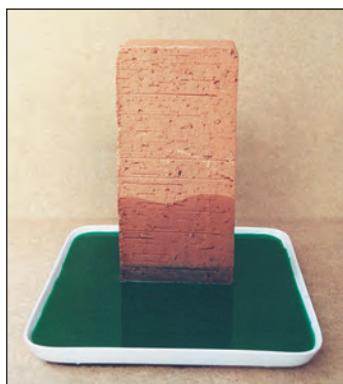
Рис. 2.38. Действие капиллярности в стеновом кирпиче после двухчасового всасывания воды
