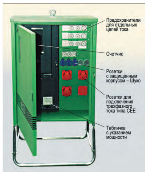
Рис. 2.98. Шкаф центрального электрораспределительного щита
