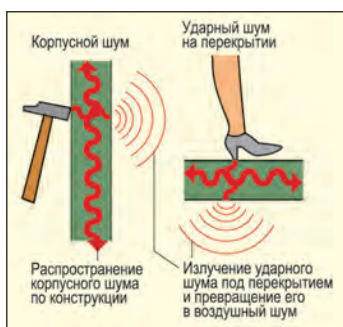
Рис. 2.85. Распространение корпусного шума
