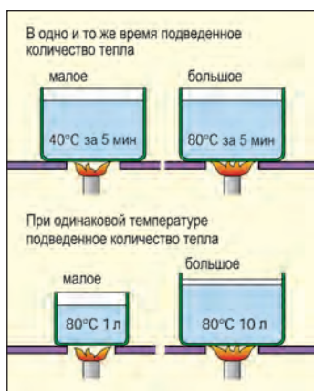
Рис. 2.75. Различие между температурой и количеством тепла
