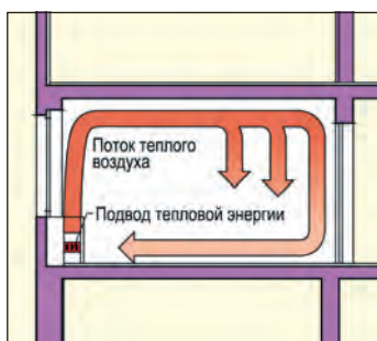
Рис. 2.81. Передача тепла за счет конвекции
