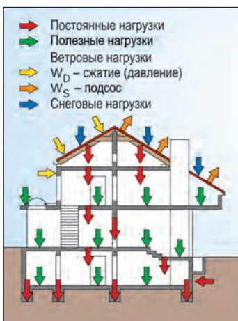
Рис. 2.59. Нагрузки на здание
