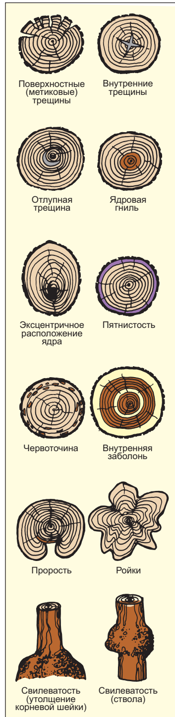
Рис. 2.19. Пороки древесины ствола (часть 2)
