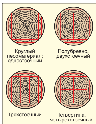
Рис. 2.37. Виды распиловки на брусья и балки
