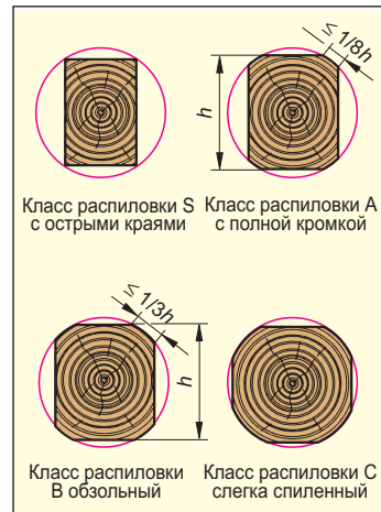
Рис. 2.60. Обзол на балках и брусках
