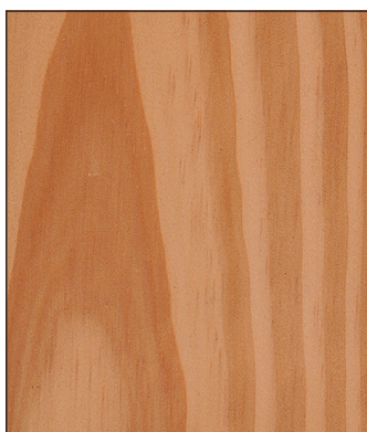
Рис. 2.28. Тангентальное или тангенциальное сечение (полосчатая текстура)
