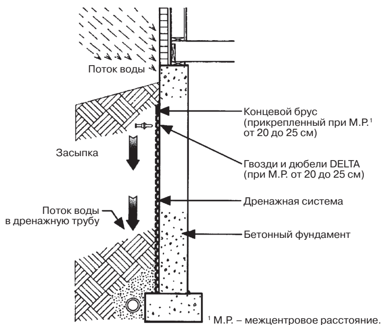
Рис. 2.7. Упрощенная схема конструкции сборной дренажной системы (предоставлено Cosell-Dorken)
