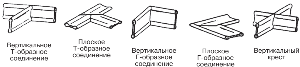
Рис. 2.29. Типичные готовые соединители (фитинги) и переходники для гидрошпонок из ПВХ ( предоставлено Tamms Industries )
