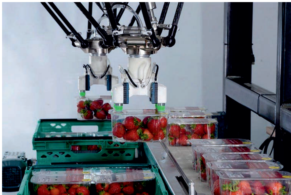
Рис. 1.2. Дельта-робот для сбора, сортировки и упаковки урожая земляники садовой с системой интеллектуального управления
