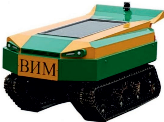
Рис. 1.5. Общий вид роботизированного транспортно-технологического средства с автоматизированным электроприводом
