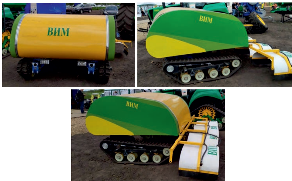
Рис. 1.9. Роботизированный гусеничный опрыскиватель для обработки сельскохозяйственных культур
