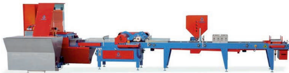
Рис. 1.10. Линия для посева семян Alfa
