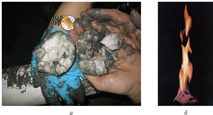
Рис. 10.19. Кусок кристаллов газовых гидратов, поднятый со дна Мексиканского залива с глубины 100 м (а) и горение газового гидрата (б)
