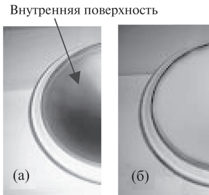
Рис. 2.22. Удаление осадка с диэлектрического купола, полученного при травлении 25 подложек с пленкой золота. Вид поверхности купола: а – до очистки и б – после очистки [26]. Режим очистки: газ Cl_2 , давление 1,0 Па, ВЧ мощность 1,5 кВт и V_m = 2000 В
