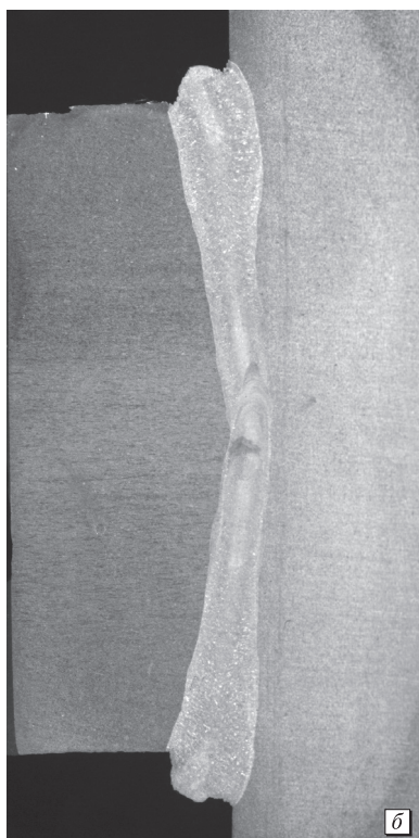
Рис. 2.30. Изделия, полученные CO 2 -лазерной сваркой для химического завода: (а) ограждение диаметром 4 м, (б) соединения стрингера толщиной 25 мм и балки
