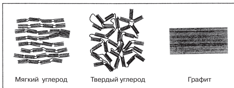
Рис. 1.12. Различие в расположении графеновых слоев у различных типов углерода
