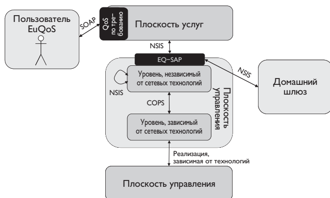
Рис. 1.2. Архитектура EuQoS (опорные точки и протоколы)
