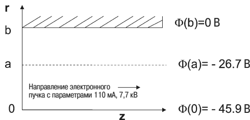
Рис. 1.32. Цилиндрический пучок электронов в канале с радиусом b и потенциалами \phi(0) в центре пучка, \phi(a) на краю пучка и \phi(b) на замедляющей системе
