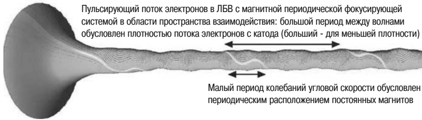
Рис. 1.22. Форма электронного пучка с «идеальной траекторией», проходящего от поверхности катода через магнитную периодическую фокусирующую систему в области пространства взаимодействия, для типичной ЛБВ Ку-диапазона. Параметры пушки Пирса: I = 150 мА, V = 7,5 кВ, диаметр канала 1 мм, заземленная трубка, B_{\text{пик}} = 0,325 Тл. (Моделирование проведено с помощью программы моделирования пушки в двумерном приближении, визуализация – с помощью условно-бесплатного программного обеспечения создания виртуальной реальности. Исполнитель В. Швертфегер, TED, Ulm. Используются различные коэффициенты относительного масштабирования r = 8 \times z )
