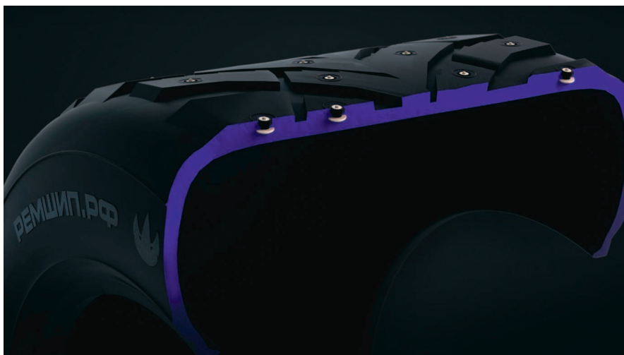
Рисунок 3.6 — 3D-визуализация ремонтного шипа компании «РемШип» в разрезе шины Michelin X Ice. Источник: https://inmotus-design.ru/portfolio/info/3d-spike-in-tire-michelin-x-ice .
