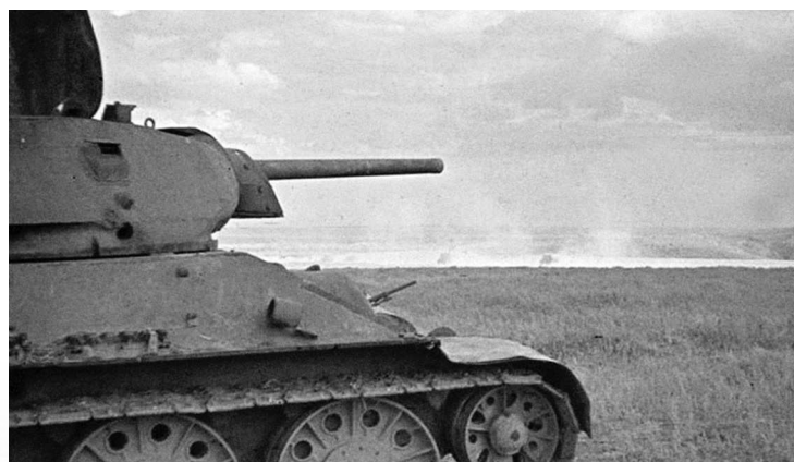
Одна из машин с верхнего снимка. Видна пробоина в борту башни ниже пробки пистолетного порта
