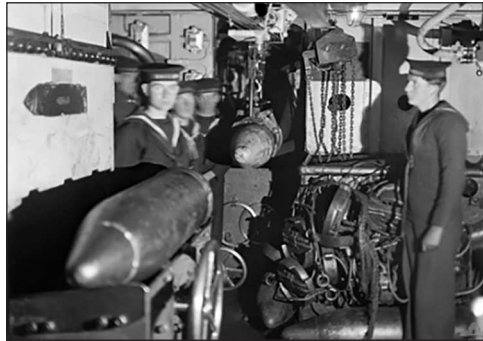
Перегрузка 305-мм снарядов в башне линейного крейсера «Аустралия»
