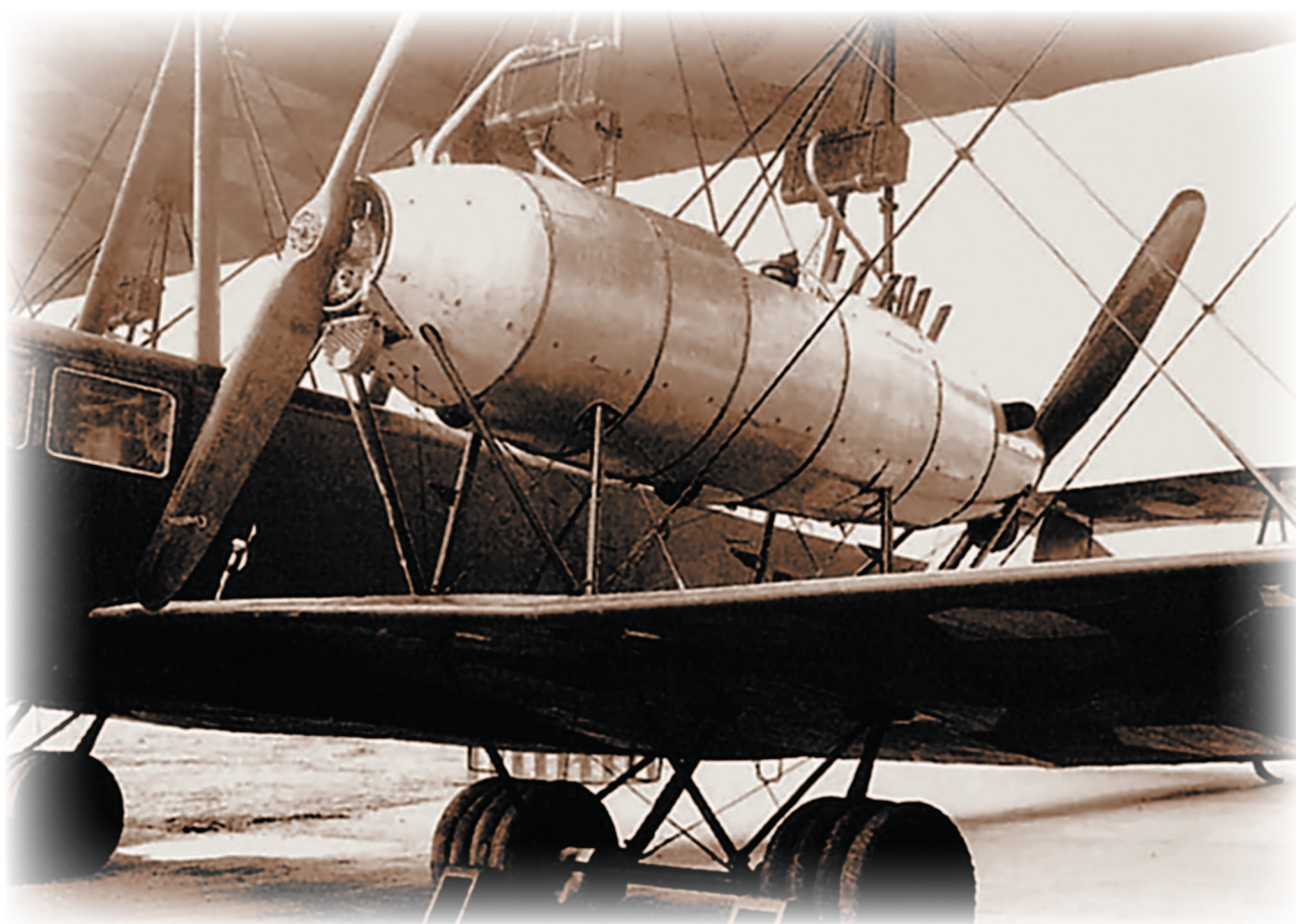
Расположенные тандемом двигатели самолета R.VI
