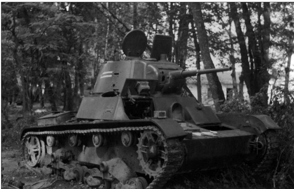
Т-26 из состава 68-го тп, оставленный из-за поломки в районе г. Броды
