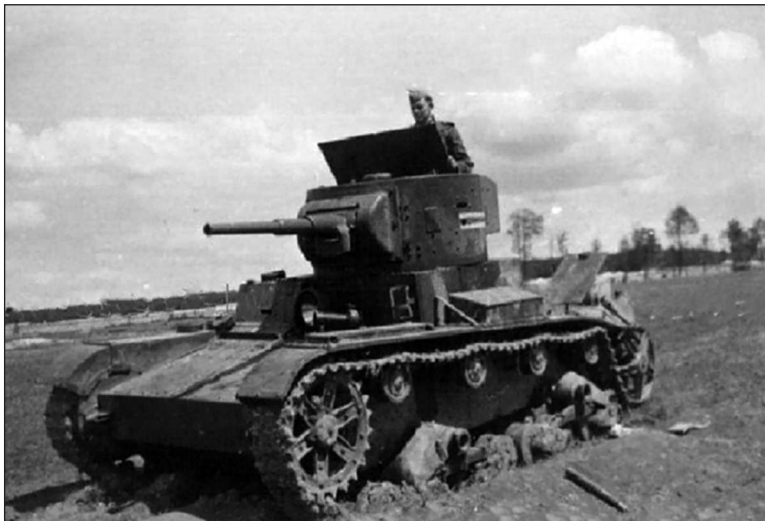
Радийный T-26 № 663 из состава 68-го тп, оставленный в Судовой Вишне с разбитым ленивцем
