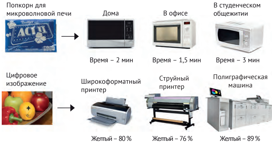
Рис. 1.1. Попкорн требует разного времени приготовления в разных микроволновых печах. Точно так же разные системы печати требуют разных пиксельных инструкций – управление цветом заключается в создании разных инструкций для получения одного и того же цвета на разных устройствах
