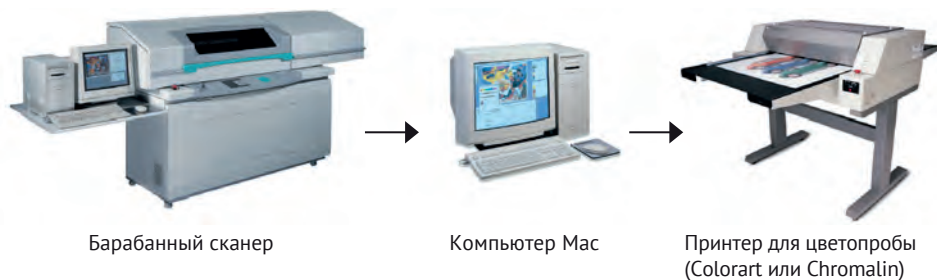
Рис. 1.2. В старые времена цифровой цвет был уделом систем высокого класса, где одна и та же компания, например Crosfield Electronics, предоставляла комплект для обработки цветных изображений, включающий барабанный сканер, монитор, программное обеспечение и систему печати цветопроб
