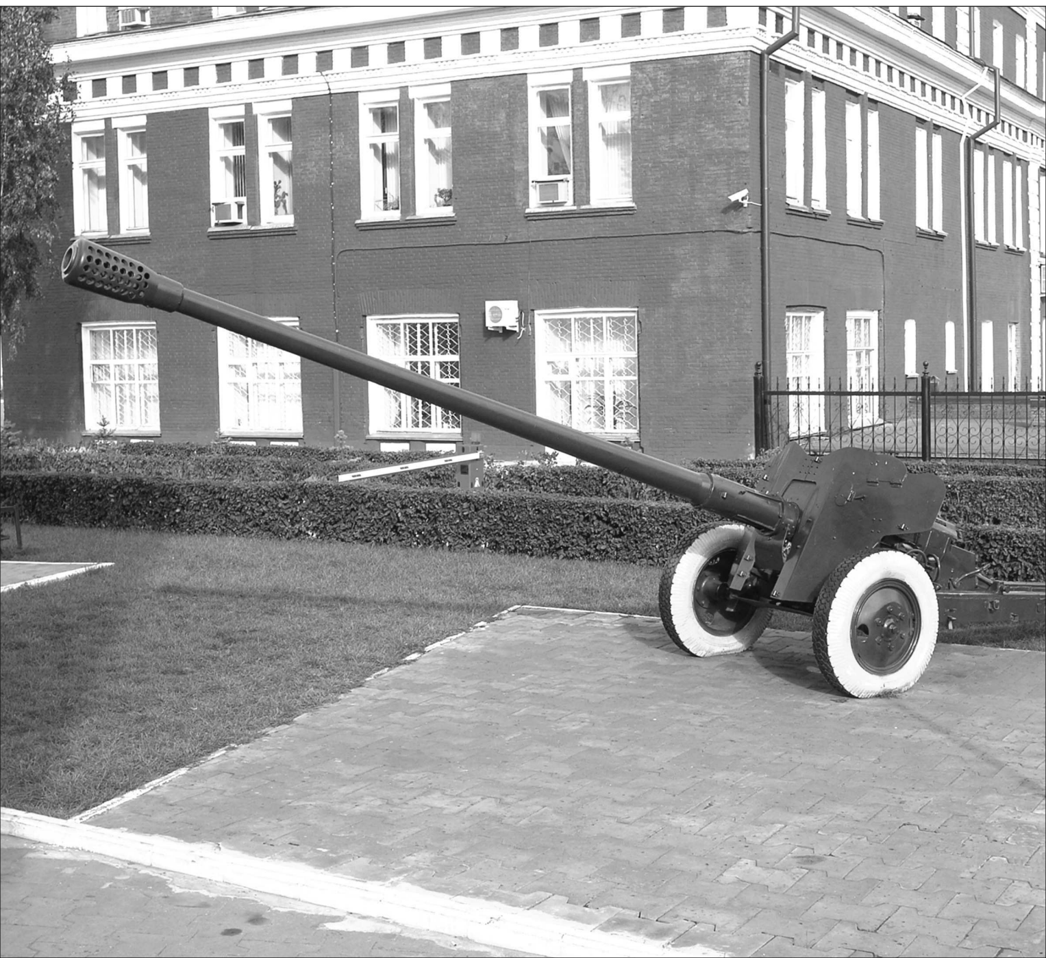
100-мм гладкоствольная противотанковая пушка Т-12
