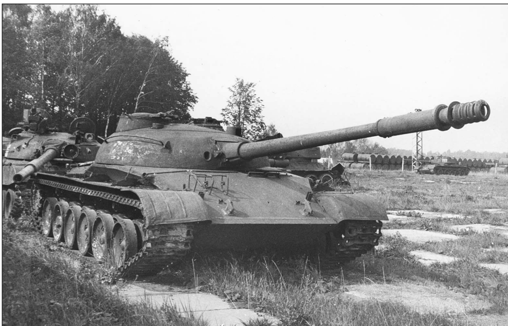
Опытный образец среднего танка «объект 140». Эта машина также вооружена 100-мм пушкой Д-54ТС
