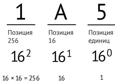
Рис. 1-4. Число 0x1A5 в шестнадцатеричной системе, разбитое по значениям на позициях
