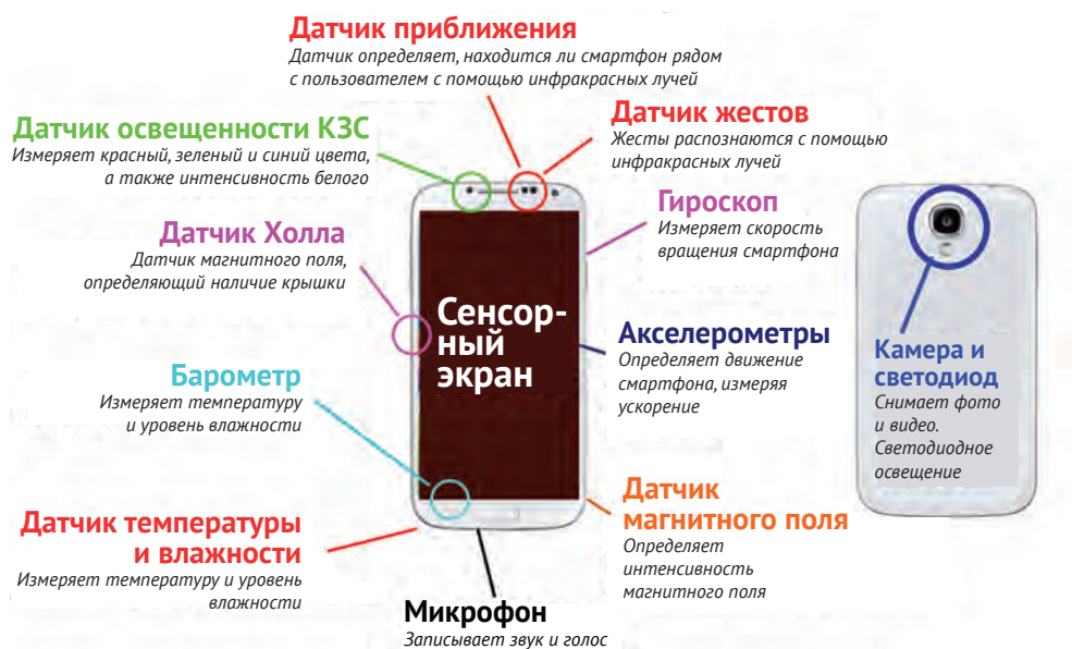
Рис. 1.2. Различные датчики смартфона
