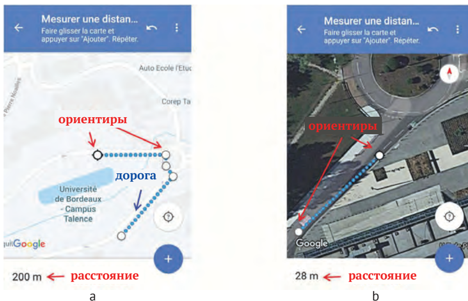
Рис. 4.10. а) Расстояние, которое было измерено с помощью Google.Maps, б) расстояние было измерено по спутниковой карте
