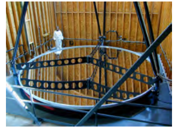
РИС. 8 Ртутное зеркало телескопа LZT
