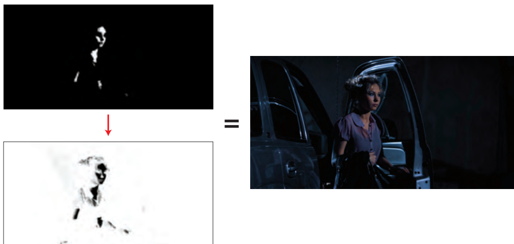
Рис. 1.9. HSL Qualification позволит выделить оттенки кожи женщины, инвертировав маску и используя результат для цветокоррекции всего, кроме ее кожи
