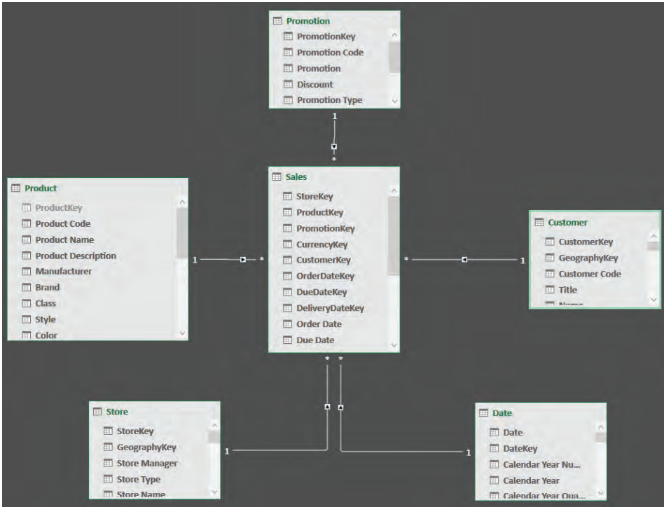
Рис. 1.12. Схема «звезда» приобретает свои очертания после расположения измерений вокруг таблицы фактов
