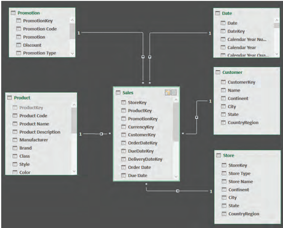
Рис. 1.14. После денормализации колонок из Geography модель вернулась к схеме «звезда»
