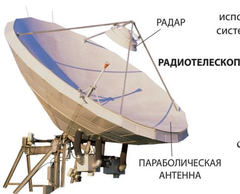
▲ РАДИОТЕЛЕСКОП: специальный прибор, который благодаря параболической антенне улавливает радиоволны, излучаемые дальними объектами Вселенной.
