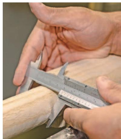
Чтобы определить внешний размер, отодвиньте подвижную планку, поместите деталь между губками и двигайте планку обратно до тех пор, пока резцы губок не прижмутся к детали достаточно плотно. Чтобы размеры не сбились, зафиксируйте планку с помощью винта.
