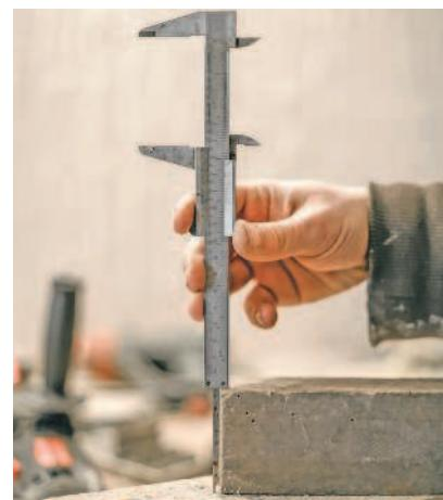
Глубиномер пригодится для измерения глубины отверстий. Выглядит как «хвостик», выдвигающийся из штанги при перемещении рамки.
