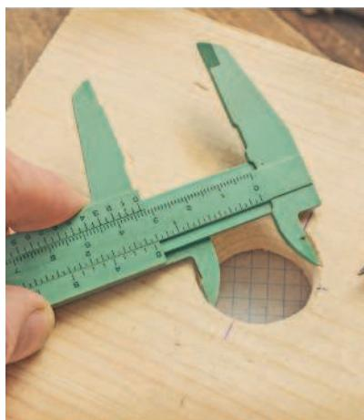
Внутренние диаметры измеряют с помощью пары губок, у которых резцы смотрят наружу; для наружных измерений служит вторая пара губок с резцами внутрь.
