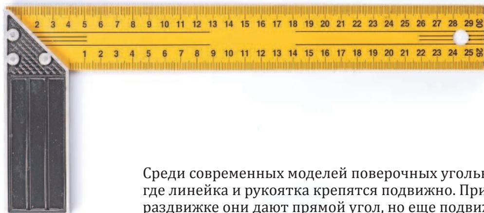
Среди современных моделей поверочных угольников есть такие, где линейка и рукоятка крепятся подвижно. При максимальной раздвижке они дают прямой угол, но еще подвижное крепление и полукруглая шкала, напоминающая транспортир, позволяют с большой точностью задавать острые углы, изменяя расположение линейки по отношению к рукоятке.
