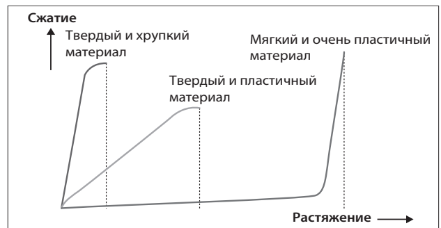
Рис. 1.4. Кривая сжатия-растяжения для хрупких, упругих и пластичных материалов
