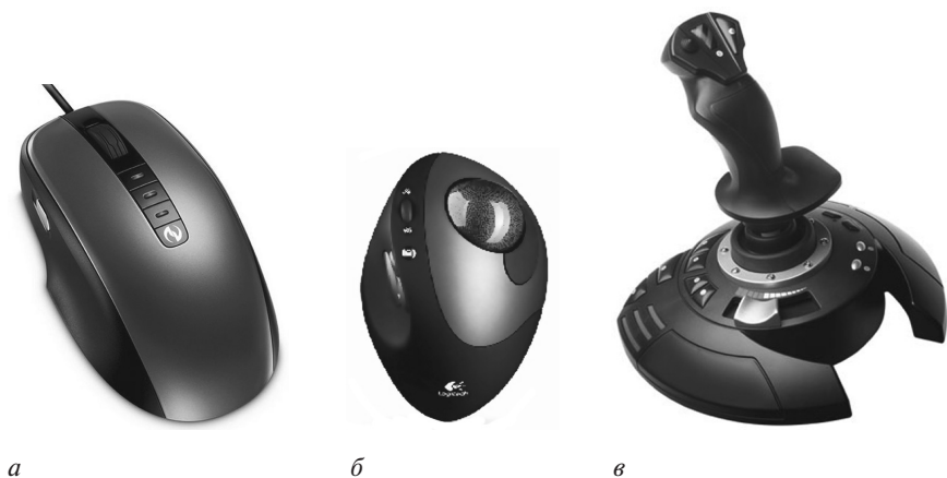
Рис. 2.27. Манипуляторы: а — мышь; б — трекбол; в — джойстик
