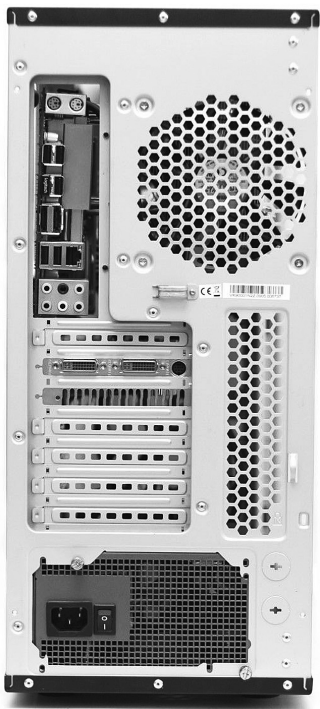
Рис. 2.19. Расположение портов на обратной стороне системного блока ПК
