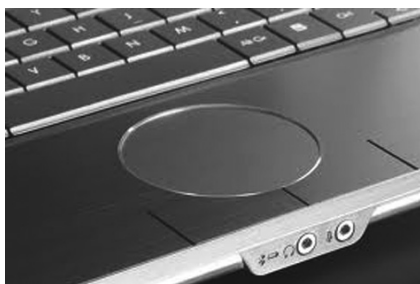
Рис. 2.28. Тачпад: а — в виде прямоугольника; б — в виде круга
